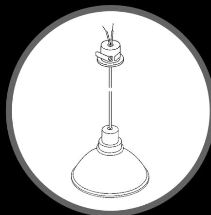
Bei Einsatz der ITB Einbaubuchse benötigen Sie eine Bohrung von genau 36mm in der Decke und einen freien Platz hinter der Decke von 40mm. Die minimale Deckenstärke ist 15mm. Die Rosette der ITB Buchse hat einen Aussendurchmesser von 40mm.
